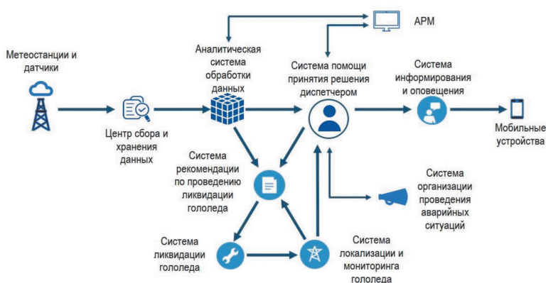
Рис. 5. Схема комплексной автоматизированной системы мониторинга, локализации и ликвидации гололеда
