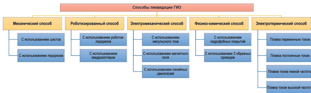
Рис.2. Способы ликвидации ГИО на проводах ВЛ
