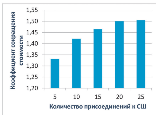
Рис. 4. График зависимости коэффициента сокращения стоимости варианта 1 в зависимости от количества присоединений 6-20 кВ
